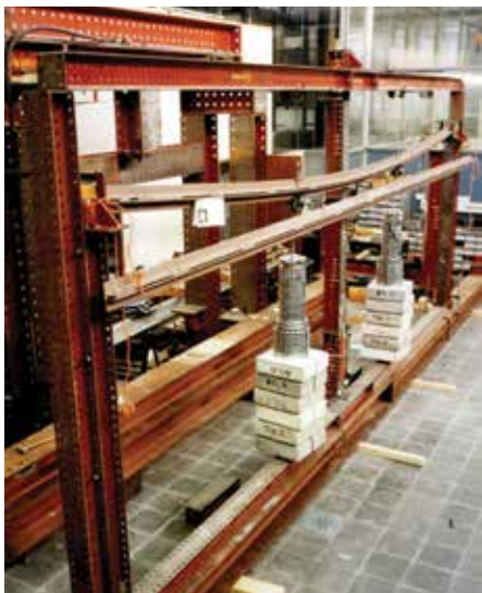
3. Proefopstelling vierpunts-buigproef (Structures Laboratory Eindhoven, TU/e).
