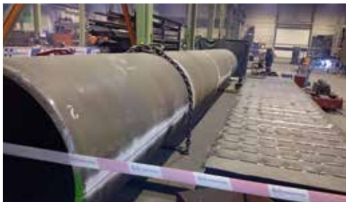
Tussen de twee hoofd draaipunten is een grote koppelkoker aangebracht zodat het val slechts op twee steunpunten rust.
